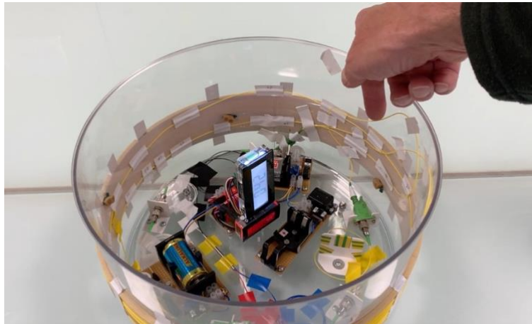
Vidéo 3 - Interféromètre à anneau de fibre, au repos, dont la fibre est soumise à des déformations
