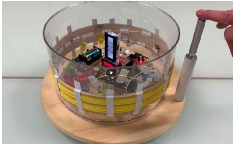
Vidéo 5 - Interféromètre à anneau de fibre mis en rotation, dans chacun des deux sens, à partir de la valeur 249 affichée au repos
